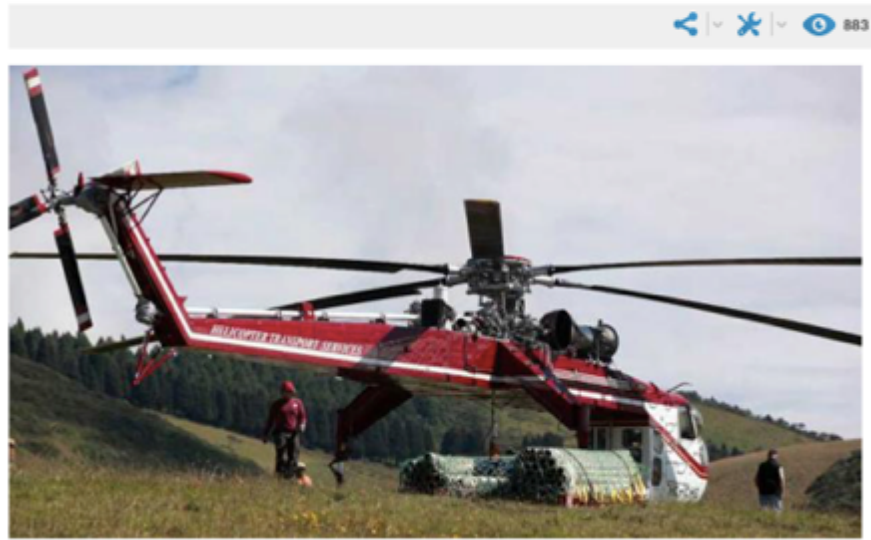
El helicóptero, que puede transportar hasta 25 toneladas de carga, completó su último viaje de traslado de material, para la construcción de sistema de agua potable, este jueves 8 de junio del 2017. Foto: Paúl Rivas / EL COMERCIO
