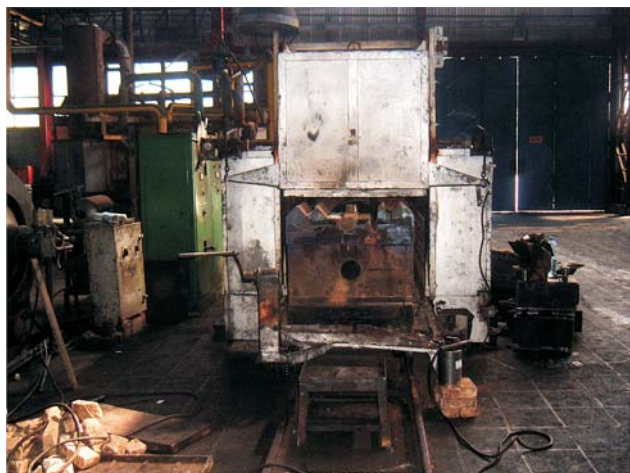
Figure 5 Preheating of the mallet in horizontal electro resistance furnace Slika 5. Predgrijavanje bata u horizontalnoj komornoj elektrootpornoj peći
