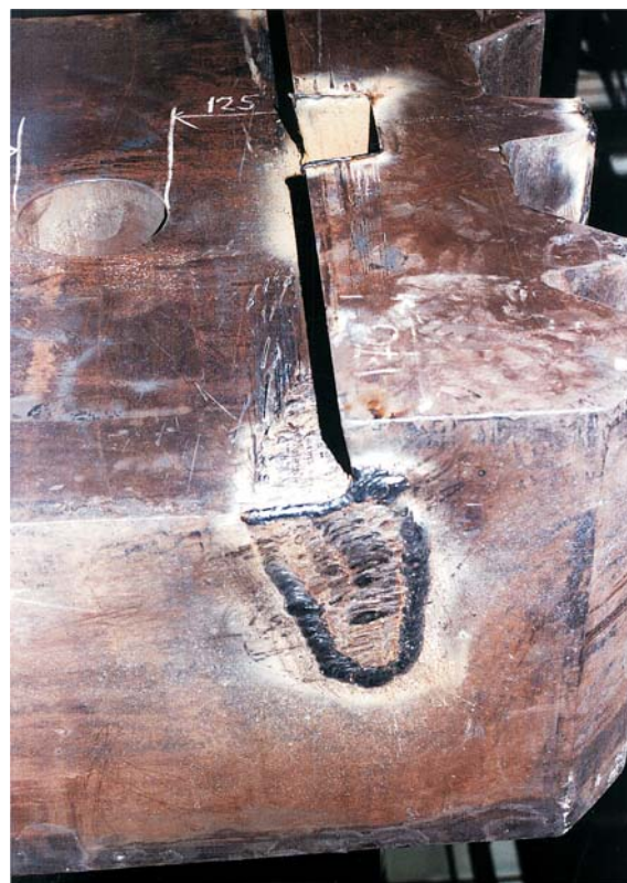
Figure 6 Appearance of mallet after hard facing Slika 6. Izgled bata poslije reparaturnog zavarivanja
