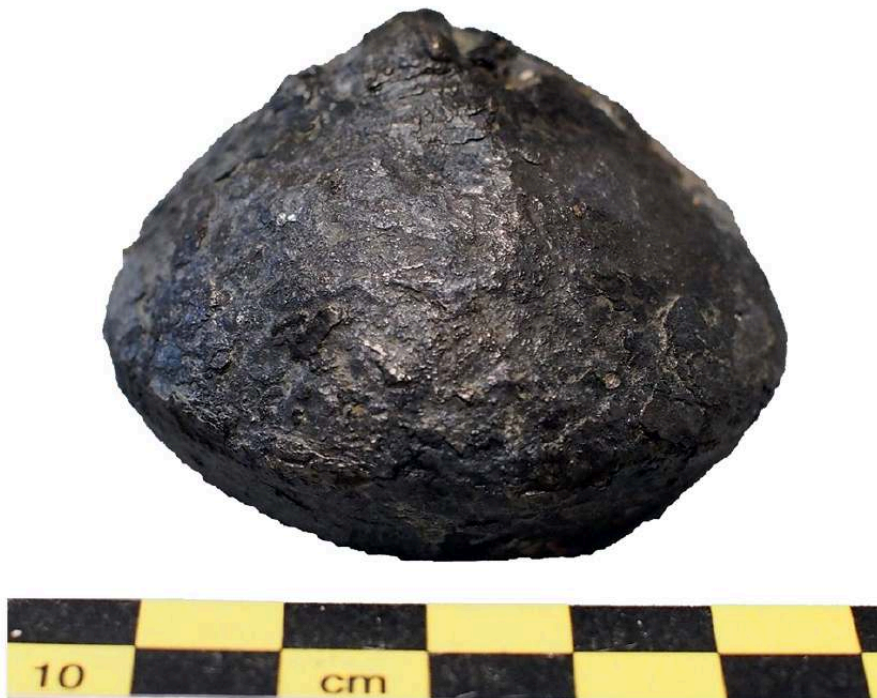
Fig. 4 – Contrepoids en plomb de balance romaine
