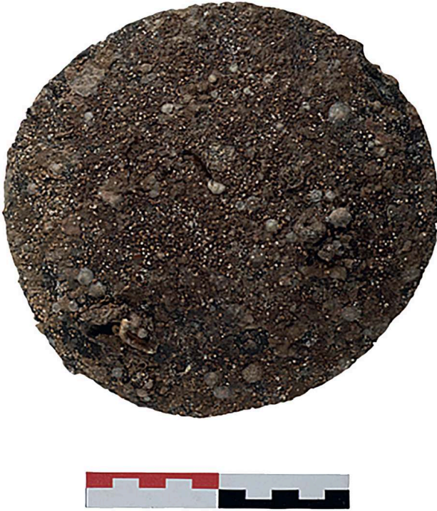
Fig. 9 – Exemple de lingot de forme discoïde plano-convexe aux contours particulièrement réguliers, en alliage plomb-étain
