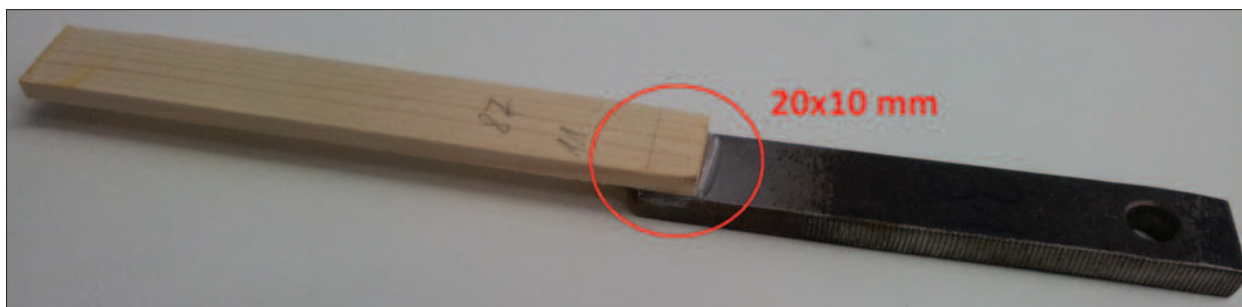
Slika 1. Geometrija preklopa lepjenca iz smrekove in jeklene lamele
