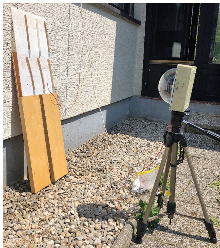
Slika 4. Postavitev preizkušancev na podlogo za merjenje odmika ob izpostavitvi zunanjim vplivom z merilno opremo (levo) in preizkušanci (desno), (foto: D. Krapež Tomec).
