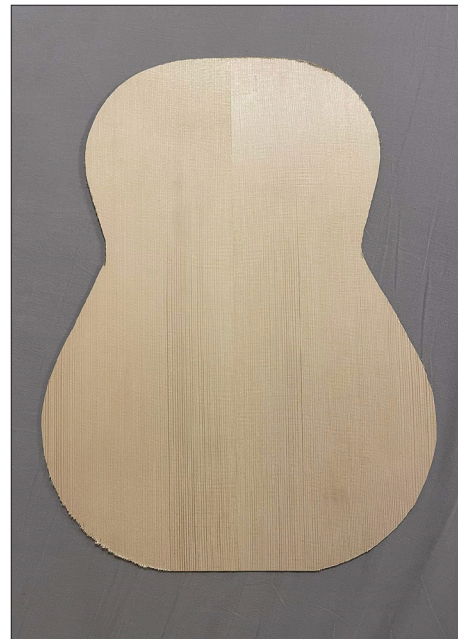
Širinsko zrcalno spojeni (zlepljeni) deski zgornje plošče kitare.
