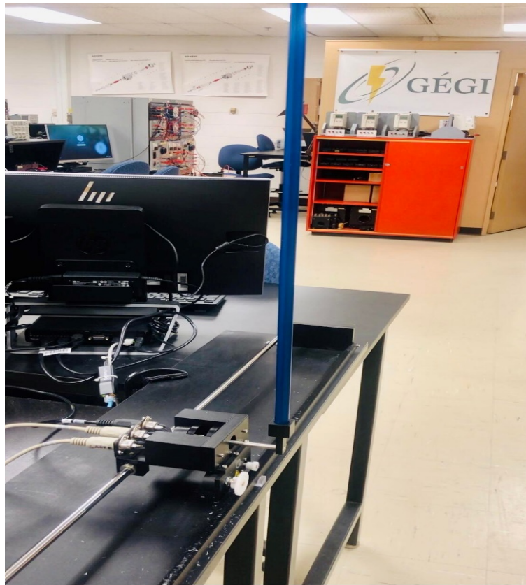
Figure 35 : Pendule inversé simple monté sur une station de test Quanser IP02 [56].
