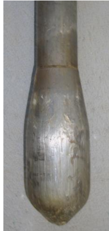
Figura 4 – Vara e ponteira usada no DPSH
