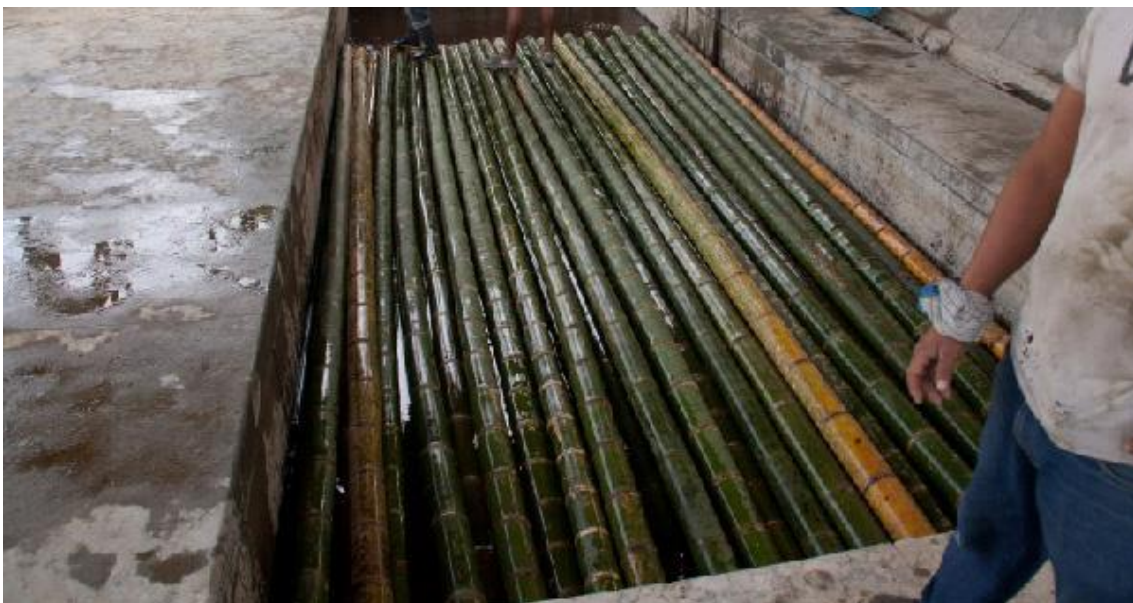
I.40 Immersion of the bamboo in water to eliminate starch and sugar / Immersione in acqua del bambù per eliminare l'amido e lo zucchero / Inmersión del bambú en agua para eliminar almidón y azúcar.
