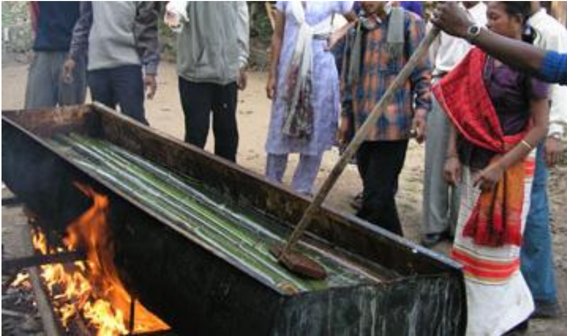
I.40 Immersion of the bamboo in water to eliminate starch and sugar / Immersione in acqua del bambù per eliminare l'amido e lo zucchero / Inmersión del bambú en agua para eliminar almidón y azúcar.
