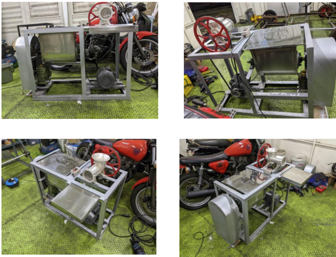
Gambar 4. Pembuatan Mesin Pengulen dan Pencetak/Pemotong Kerupuk Mlarat
