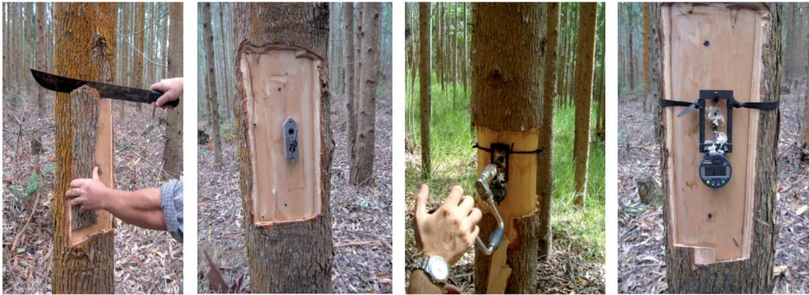
**Figura 1.** Mensuração (esquerda para direita) da deformação residual longitudinal (DRL) nas árvores de *Eucalyptus* spp.
