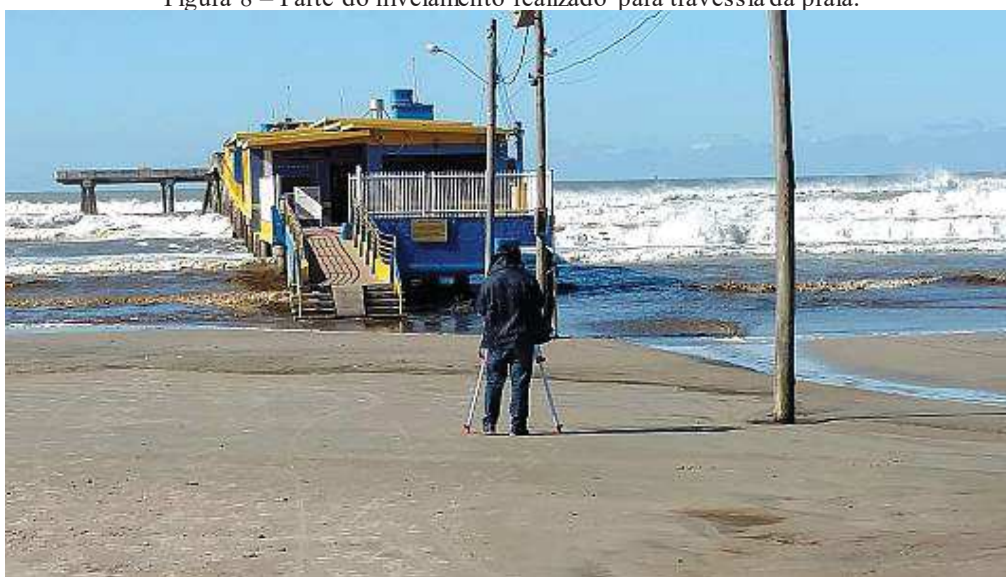
Figura 8 – Parte do nivelamento realizado para travessia da praia.
