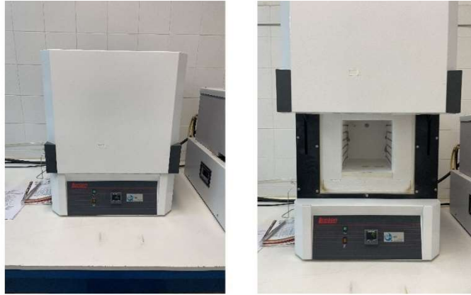
Figura 6: Mufla de laboratorio utilizada para aplicar el tratamiento térmico a las láminas de \text{IrO}_2 dopadas con Co.
