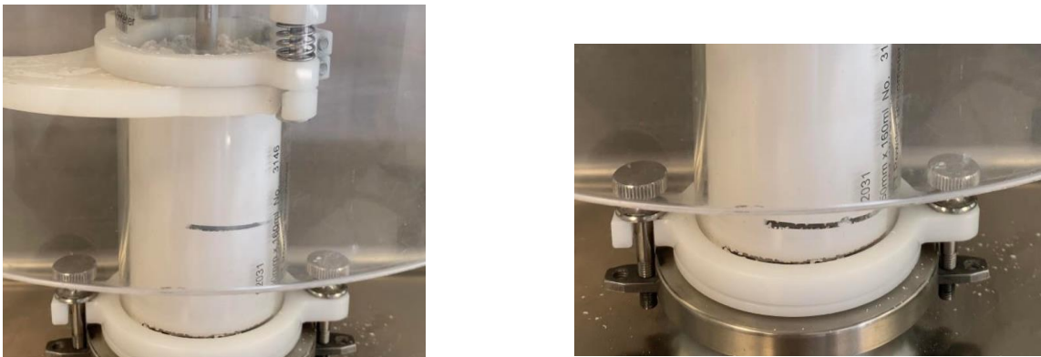
Figura 5.5.1 Ilustración del “corte” y del movimiento en vacío que realiza el aspa cuando el polvo es muy fino.
