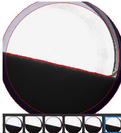
Figura 4.6.5 Foto tomada del grupo de partículas de 1-1,2 mm donde se aprecia la falsa avalancha.
