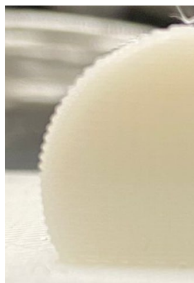
Figura 37: Distorsión por curvas en una pieza real
