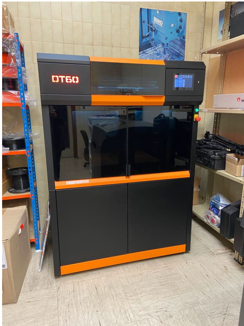
Figura 1: Impresora DT60 de tecnología FDM
