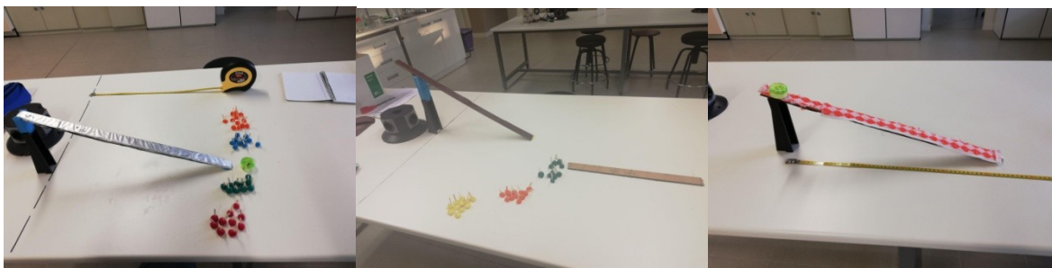
Figura 25. Fotografías de los materiales utilizados que modifican la superficie de los listones y resultados de experimentación desarrollados en el laboratorio (trapo de cocina, papel de lija, papel de aluminio)
