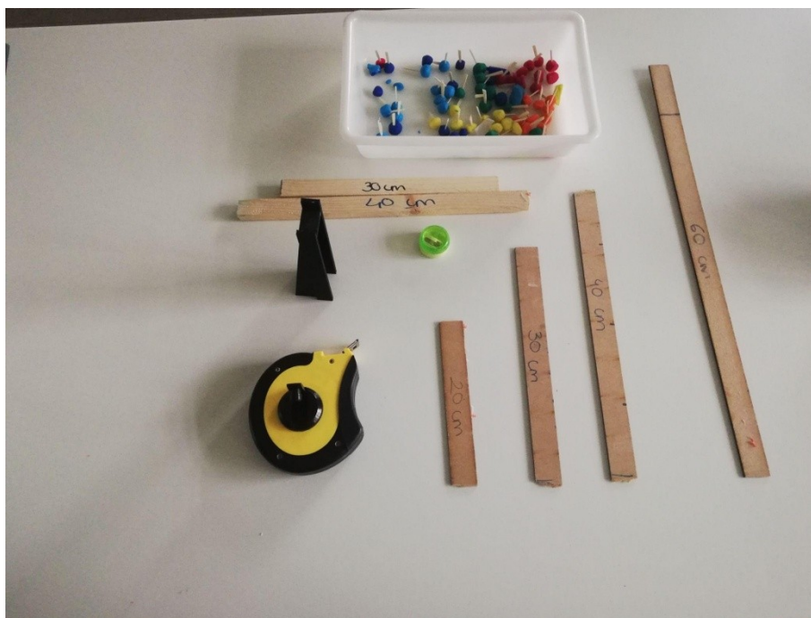
Figura 17. Materiales de experimentación. Se incluye en esta fotografía tanto el metro utilizado, el soporte de inicio, el sacapuntas (móvil), los listones utilizados y los indicadores de alcance (banderas; pie de plastilina con palillo).
