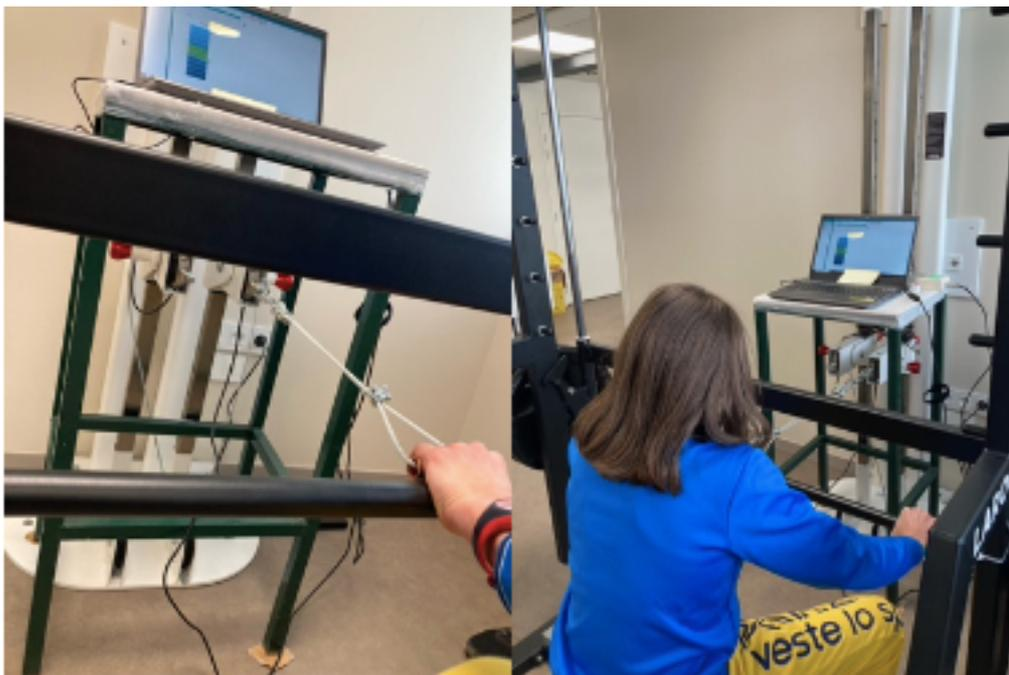
Figure 3: Test d'endurance de la force de serrage
