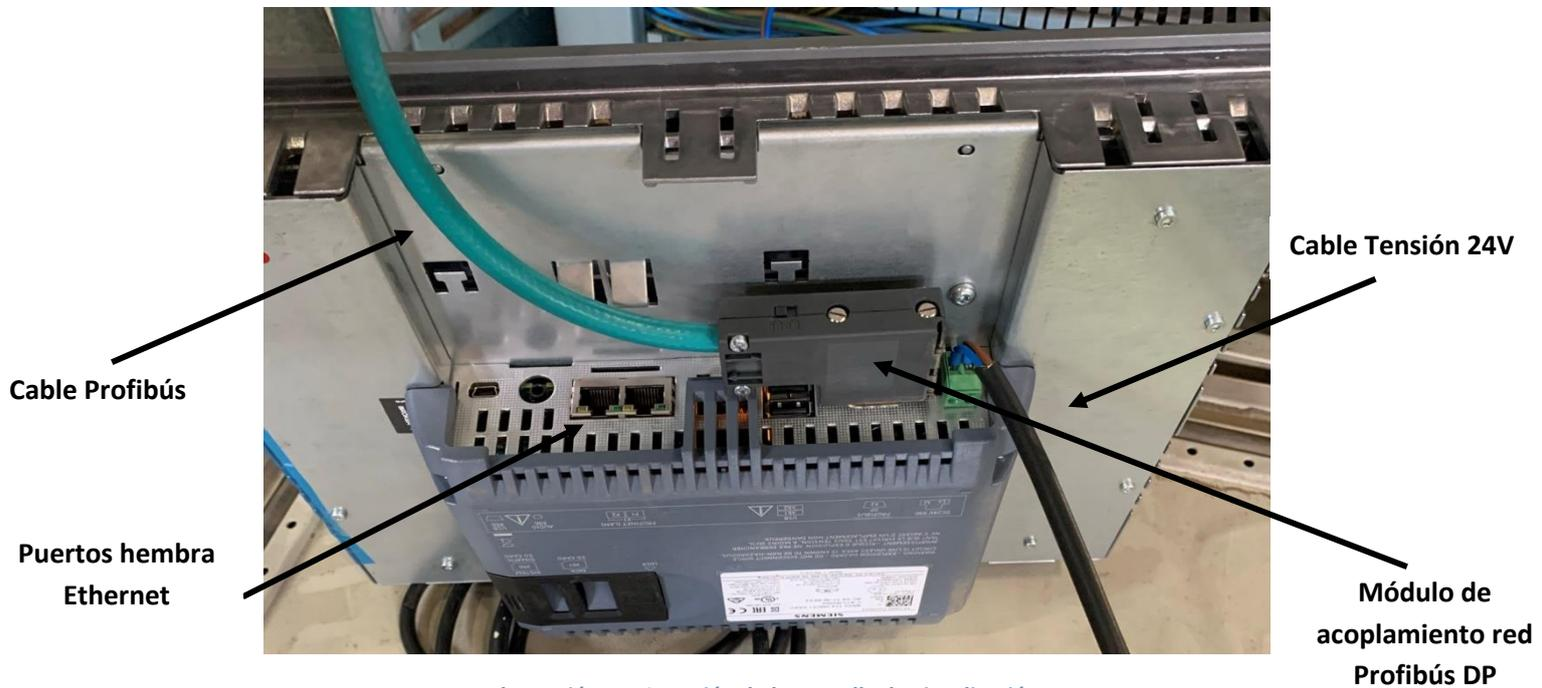
Ilustración 44. Conexión de la pantalla de visualización
