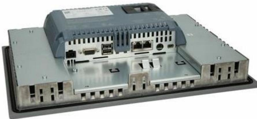
Ilustración 36. Pantalla táctil vista trasera (Soluciones & Servicios, 2021)
