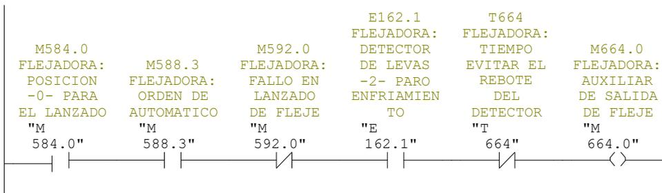
Segm.: 3 CONTACTOR LANZADO DE FLEJE
