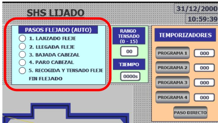
Ilustración 27. Implantación de pasos del proceso en visualización
