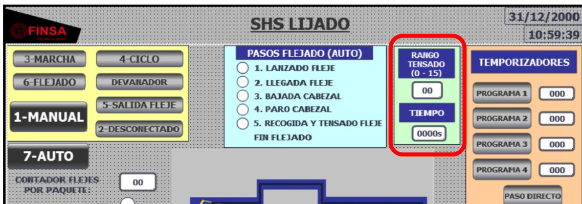
Ilustración 18. Implantación tiempos de tensado en visualización
