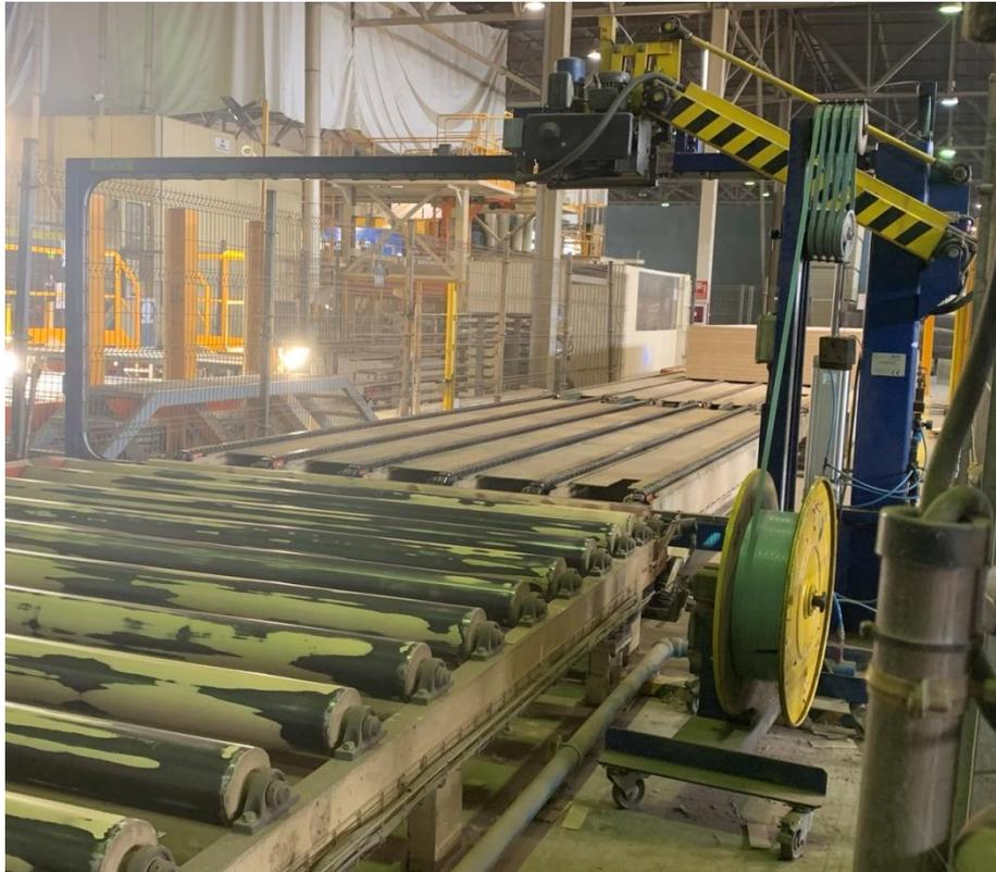
Ilustración 1. Vista frontal de la máquina flejadora
