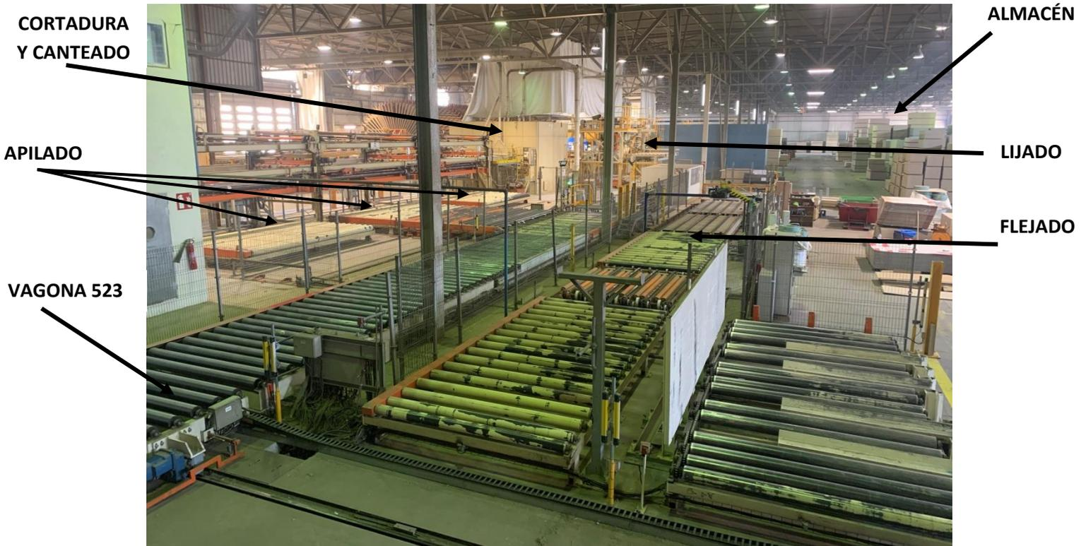
Ilustración 2. Vista real de la línea de producción
