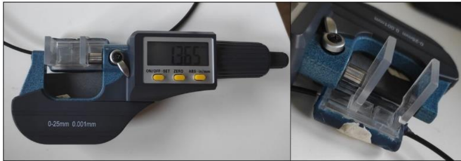
Figura 53. Montaje con micrómetro digital Beslands
