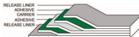
Figura 12. Estructura PSA ARcare® 8939
