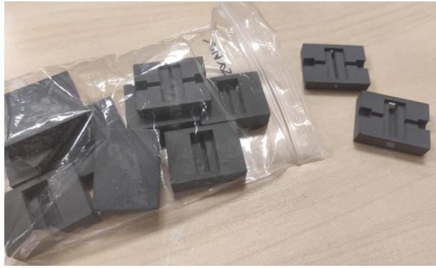
Figura 28. Soportes impresión 3D con diferentes diámetros para tubo
