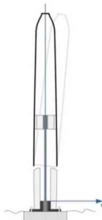
Figura 3. Estructura del aerogenerador Vortex Bladeless.
