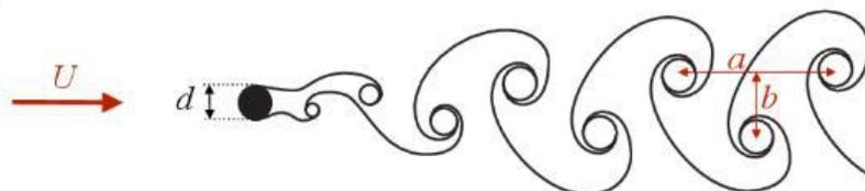
Figura 16. Calle de vórtices Karman, en la estela de un cilindro.
