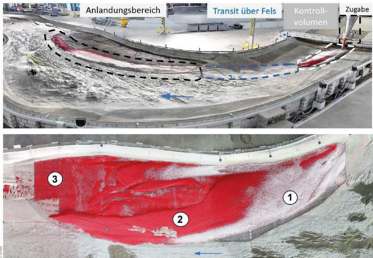
Bild 9: Oben: Funktionsbereiche im Modell, stationärer Versuch mit Sedimentanlandung auf unbeweglicher Kiesbank, unten: instationärer Versuch mit vollbeweglicher Kiesbank. (Quelle: BAW)
