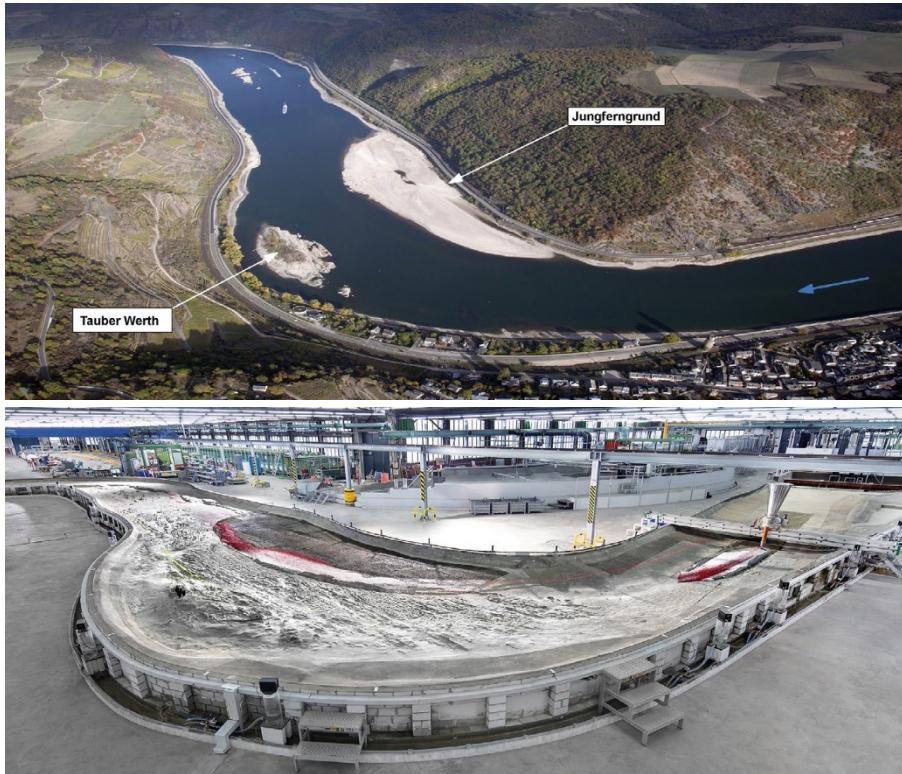
Bild 1: Oben: Schrägbildaufnahme des Rheins bei Oberwesel (Datum 23.10.2018), unten: großmaßstäbliches Modell Jungferngrund (ML 1:60 / MH 1:50). (Quelle: oben: WSA Rhein, unten: BAW)
