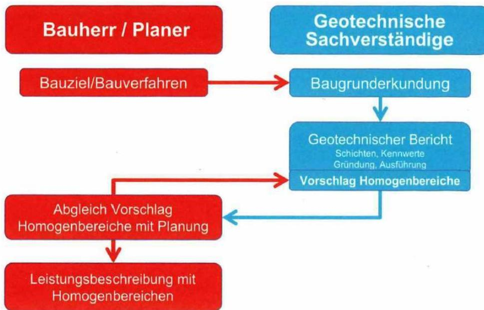
Bild 1: Workflow für die Zusammenarbeit zwischen Planer und Geotechnischen Sachverständigen
