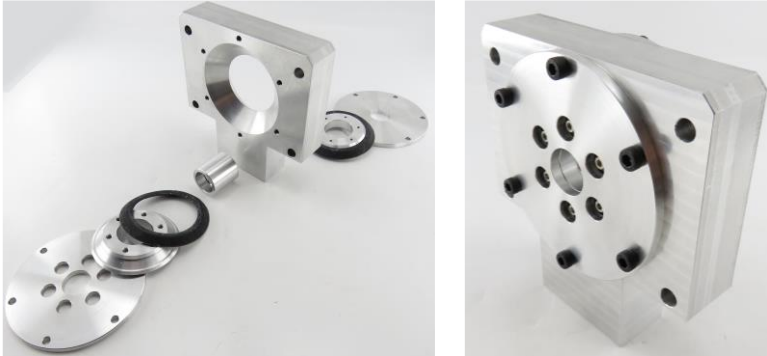
Abbildung 6.5: Gefertigtes einstellbares Lagersitz-Steifigkeits-Element. Links: Bauteile des einstellbaren Lagersitz-Steifigkeits-Elements (Schobloch, 2020, S.VI) 2 , rechts: Montiertes Element
