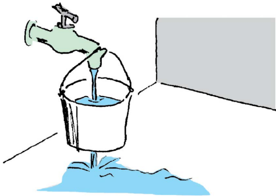
Abb. 2.25 Durch das Loch fließt genauso viel Wasser ab, wie aus dem Wasserhahn zufließt. Die Wassermenge im Eimer bleibt konstant.
