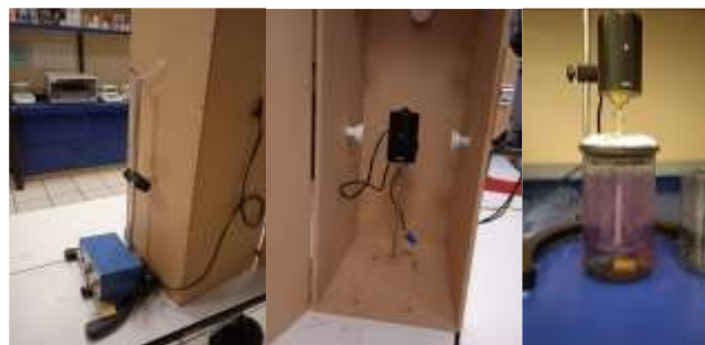
Figura 5. Construcción y montaje del reactor fotocatalítico.
