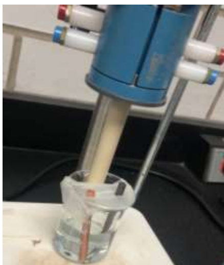
Figura 1. Representación de la celda de tres electrodos, a) Electrodo de trabajo, b) electrodo de referencia y c) -- contraelectrodo.
