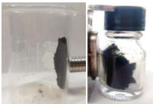
Figura 10. Atracción magnética de a) NPM-Fe/MNT NaOH y b) NPM-Fe/MNT NH 4 OH .
