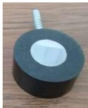
Figura 2. Detalle final de una probeta de acero AISI 8620 montada en baquelita.
