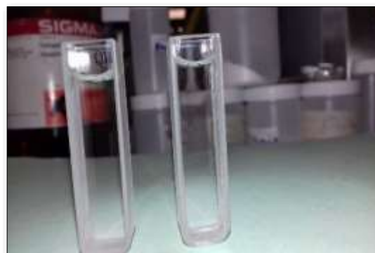
Figura 7. Cubetas con decoloración total del Black 5, con luz UV usando el TiO 2 -Grafito-Eu-Ag.
