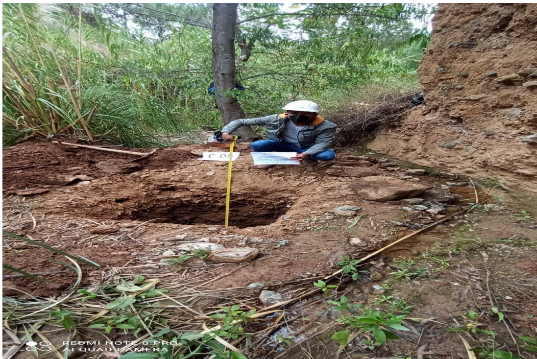
En la imagen se puede apreciar al Tesista indicando parte las excavaciones que se realizaron para la obtención de las muestras del suelo.
