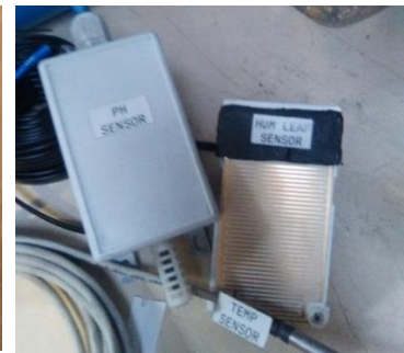
Fig. 4. Sensores de estado del agua y cultivo sistema.
