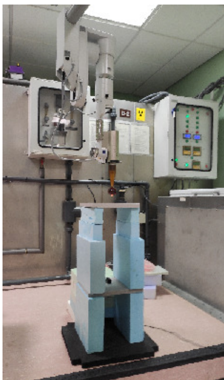
Figura 4.6: Montaje HVL (imagen propia).
