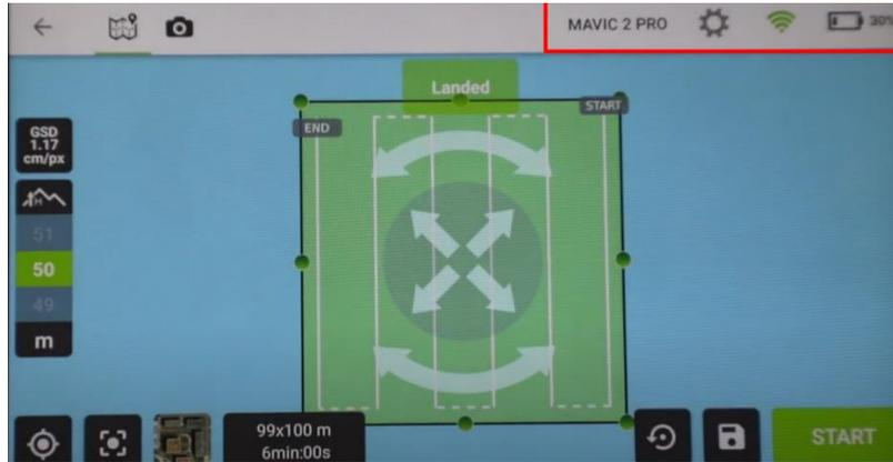
*Nota:* En la figura se observa el tipo de misión poligonal escogida a realizar. *Elaborado por:* Autores, 2022.
