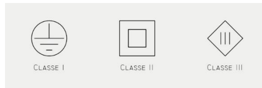
Figura 14: Símbolos das diferentes classes dos equipamentos de acordo com a proteção contra choques elétricos
