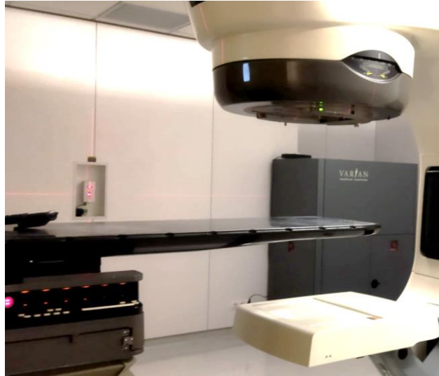
Figura 8 - Cama de tratamento do acelerador linear
