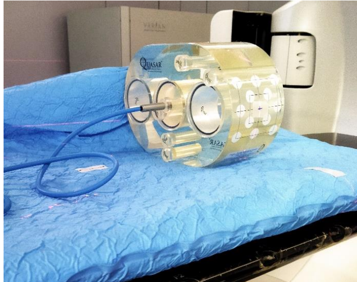
Figura 26 – Fantoma Quasar com câmara de ionização
