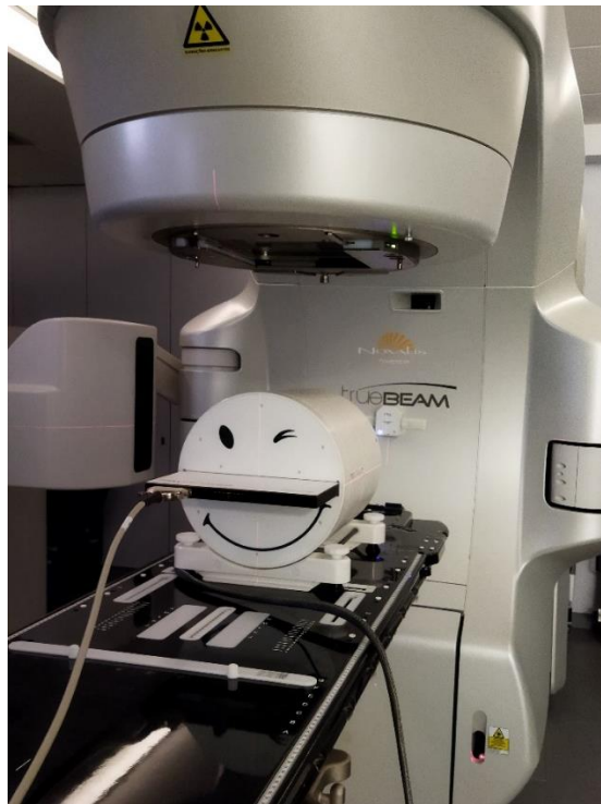
Figura 17 – Fantoma Octavius 4D com a matriz Detector 1500 inserida
