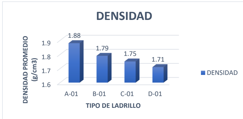
Figura 45. Comparación de densidades por tipo de ladrillo
