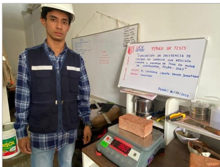
Figura 44. Pesado de muestra y de ensayo de adsorción
