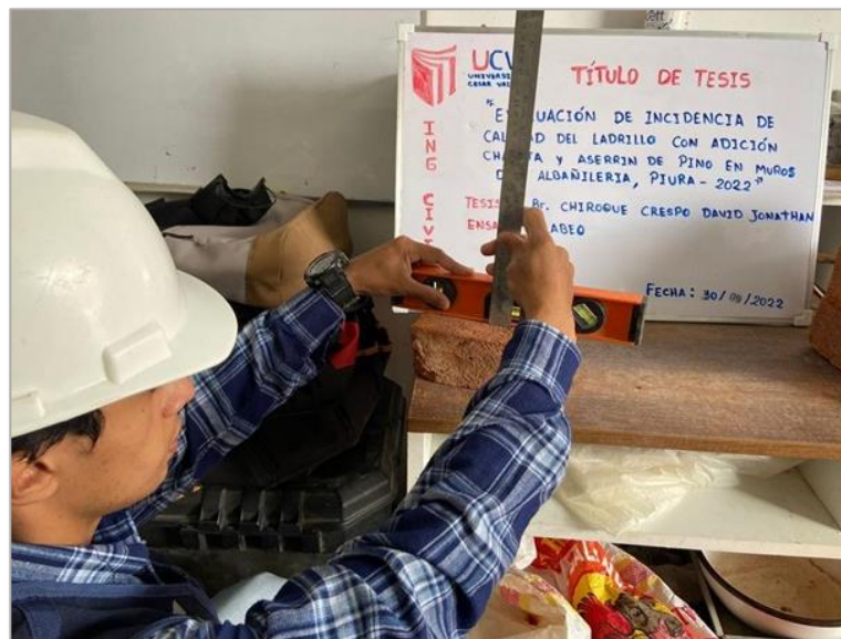
Figura 36. Realizando ensayo de variación dimensional
