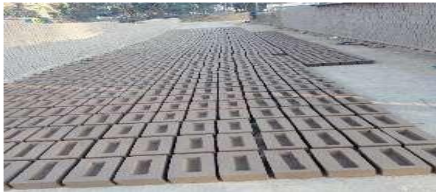
Figura 7. Secado del ladrillo artesanal al ambiente
