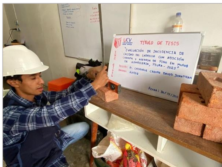
Figura 37. Obteniendo datos de lo cóncavo y convexo del ladrillo
