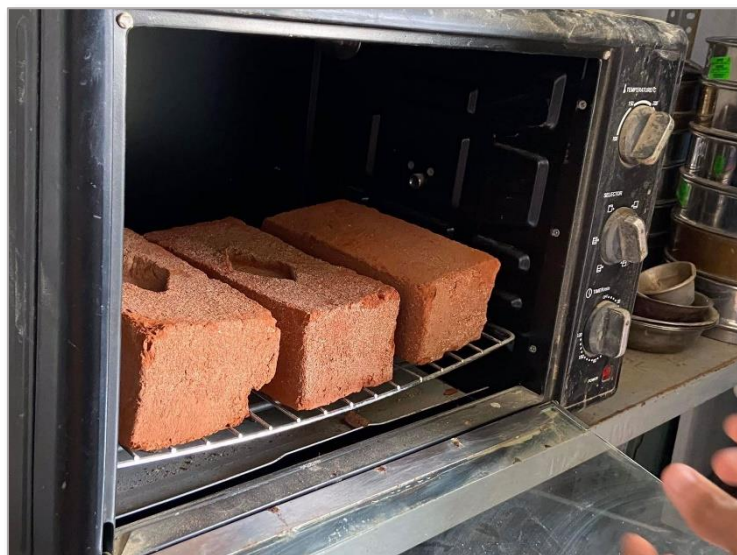
Figura 46. Ladrillos colocados al ladrillo durante 24 horas
