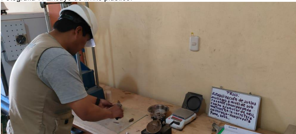
Fotografía 8. Ensayo limite líquido con la cuchara de Casa Grande.
