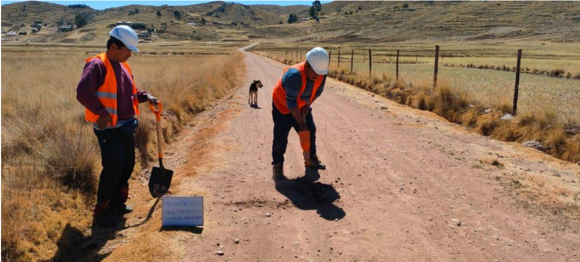
Fotografía 1. Selección del sitio para la calicata 01 en el tramo 00+250, carretera Cochiraya - Huayrapata.
