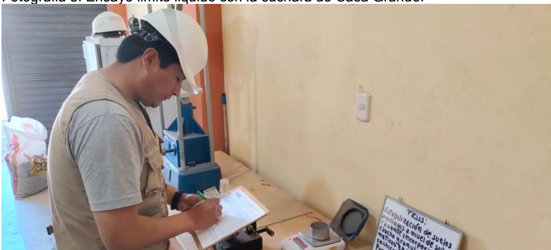
Fotografía 9. Ensayo del contenido de humedad, pesaje de la muestra en la tara.
