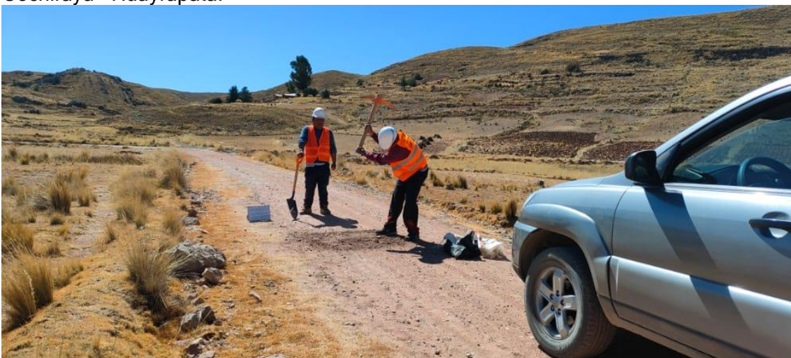
Fotografía 3. Selección del sitio para la calicata 03 en el tramo 01+100, carretera Cochiraya - Huayrapata.
