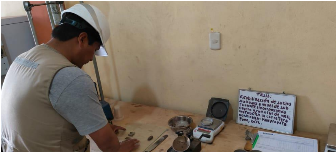
Fotografía 7. Ensayo de límite plástico.
