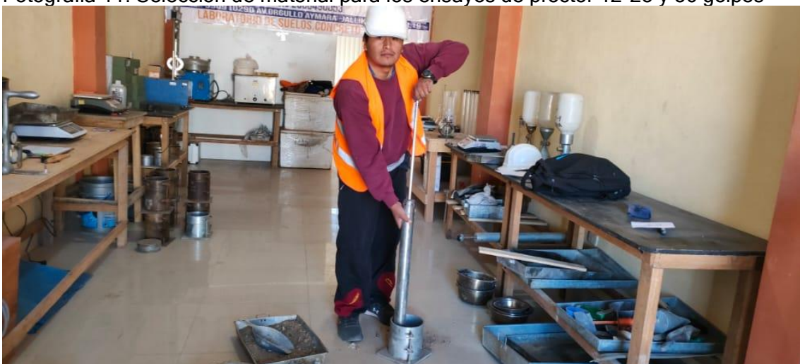
Fotografía 12. Ensayo de proctor para una muestra de 56 golpes.
