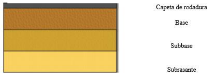
Imagen 6.-Sección de un pavimento flexible
