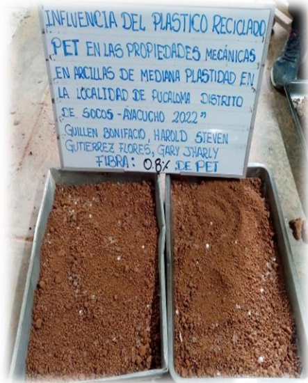
Foto N° 24 Muestra de arcilla de 6kg. Con PET
