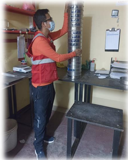
Foto N° 13 Proceso de tamizado de la muestra de arcilla
