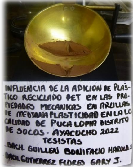
Foto N° 16 Cuchara de Casagrande con arcilla
