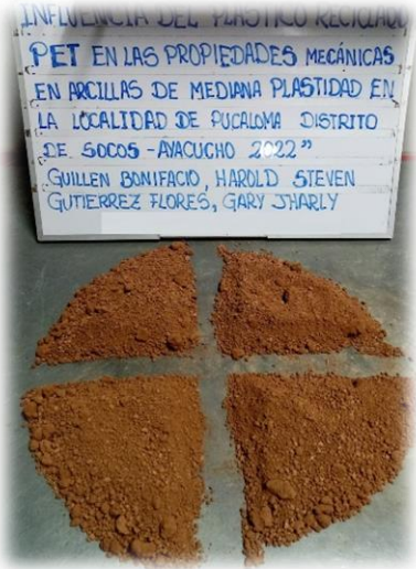
Foto N° 12 Cuarteo de la Muestra representativa
