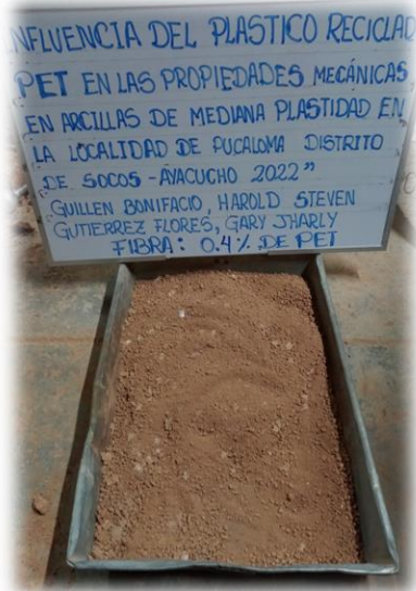
Foto N° 22 Muestra de arcilla de 6kg. (CBR)
