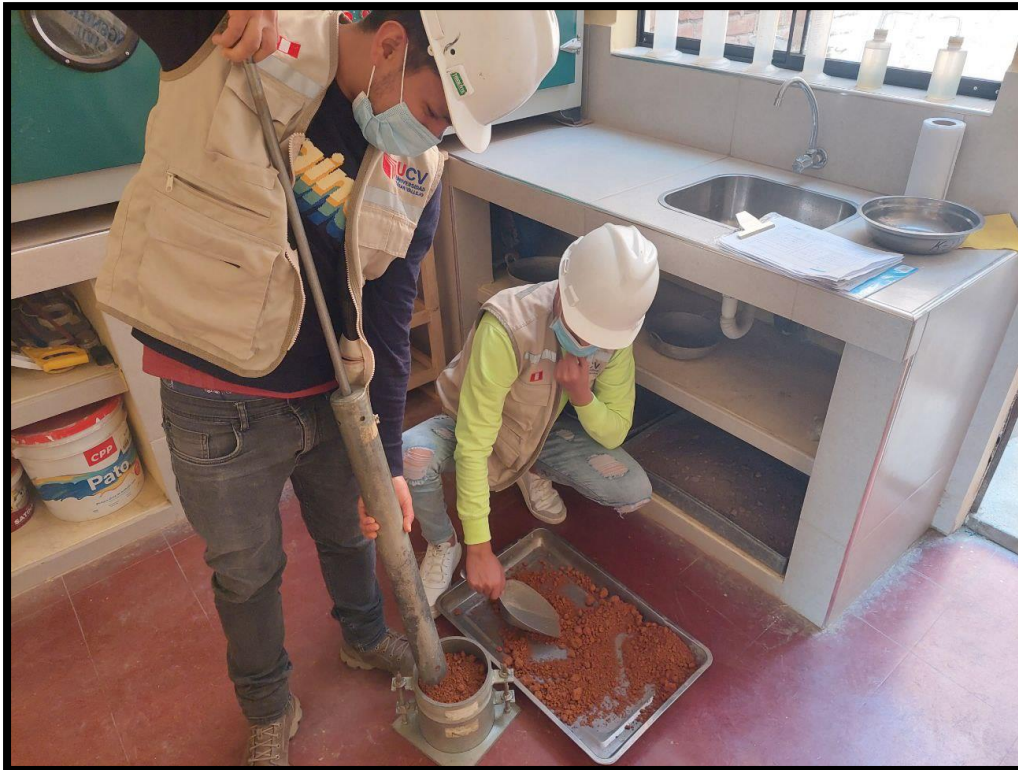
Fotografía N° 17: Compactación de muestra con pisón.
