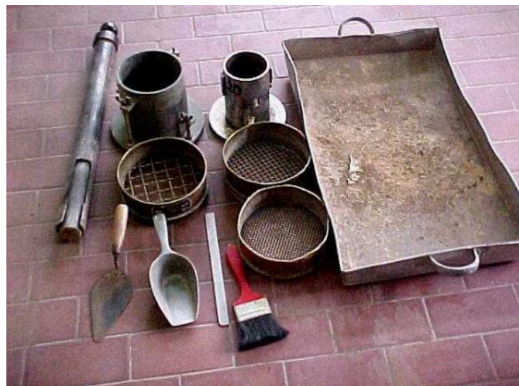
Figura 2. Procedimiento del ensayo de proctor modificado
