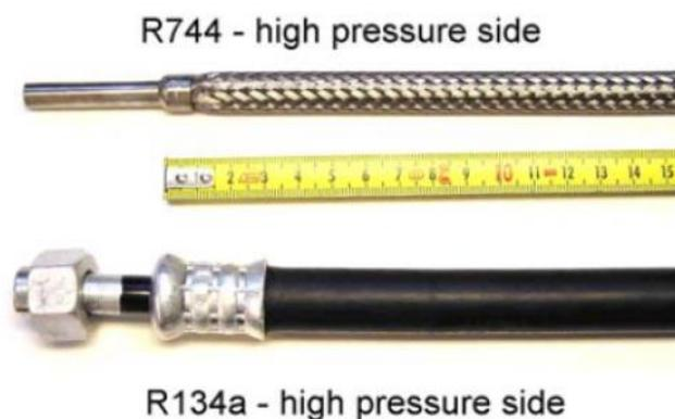
Figura 4.24 – Secção das tubagens de R744 (CO<sub>2</sub>) e R134a, Balmer *et al.* (n.d.).
