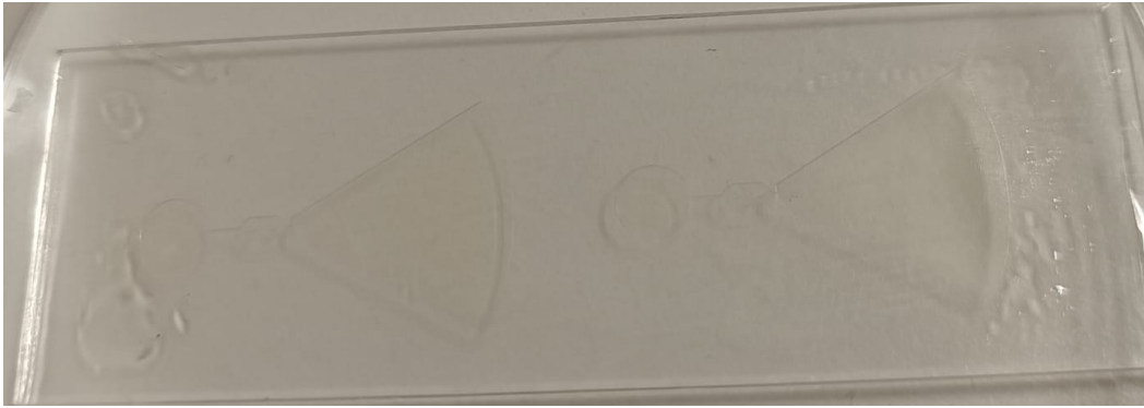
Fig. 20: Motlle dels dissenys d'amplada de vàlvula de 50 i 100 \mu\text{m}
