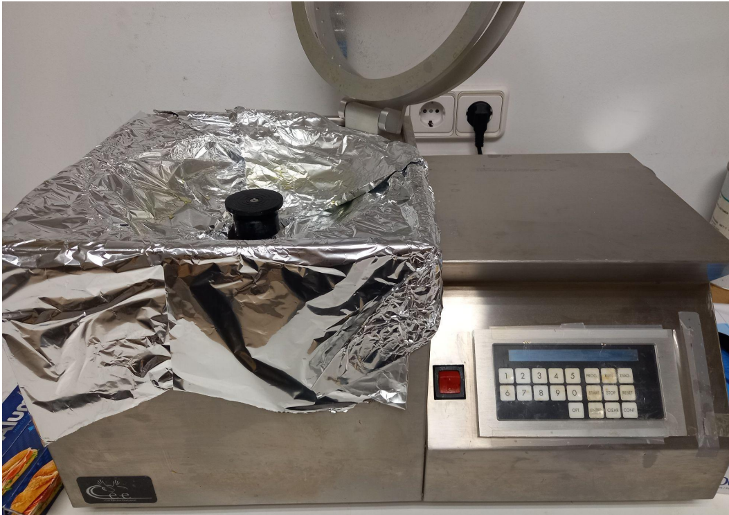
Fig. 15: Spinner recobert amb paper d'alumini
