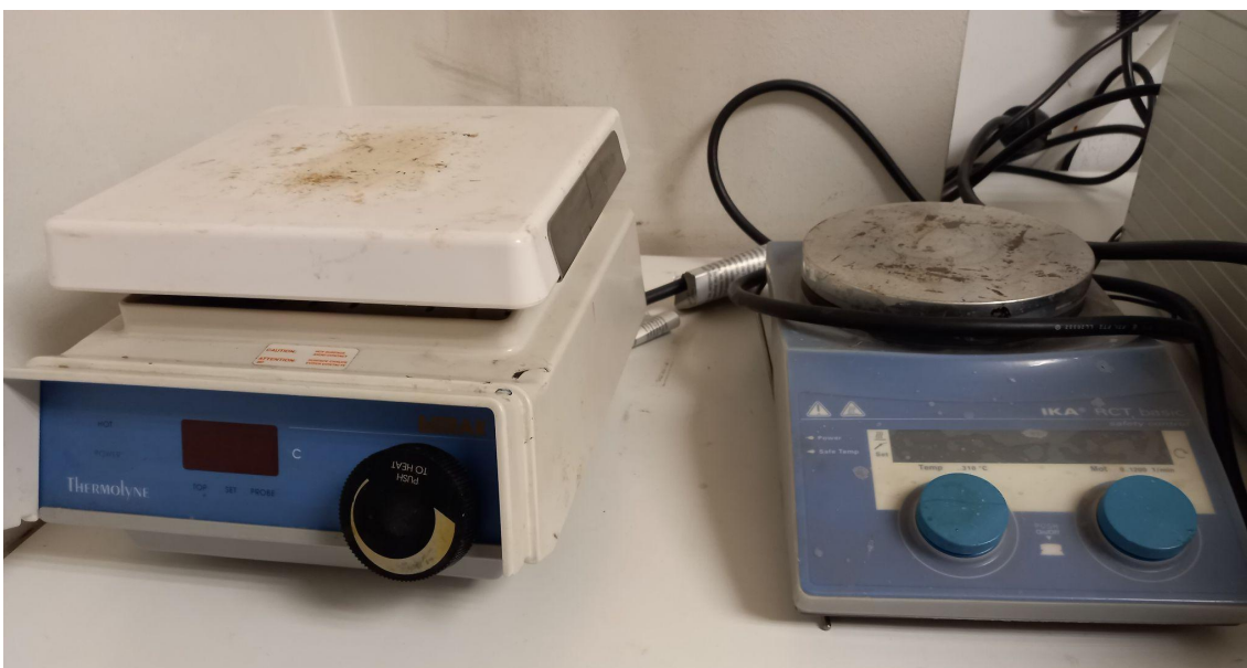
Fig. 16: Hot plates amb sensor integrat (esquerra) i extern (dreta)
