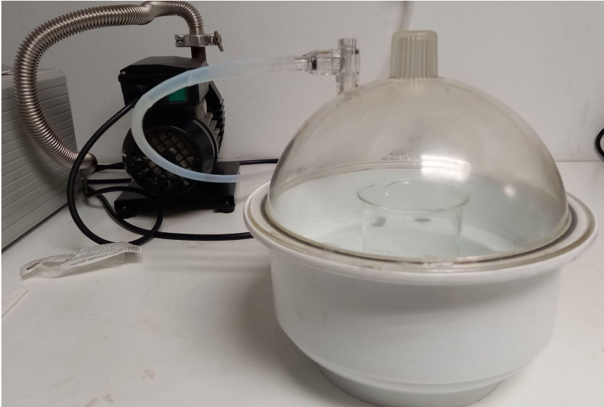
Fig. 17: Bomba i cambra de buit
