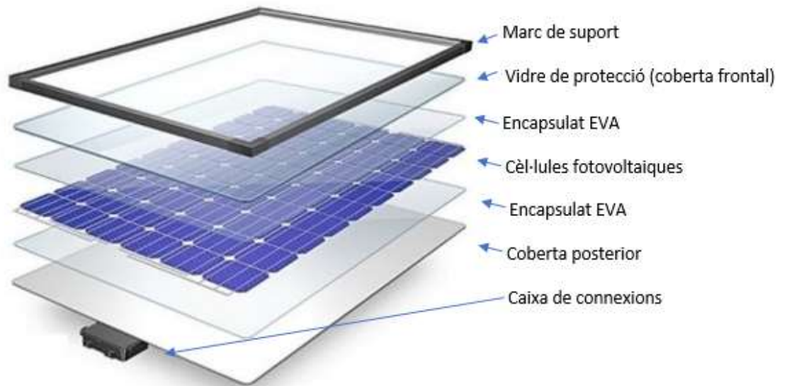
Il·lustració 13. Estructura d'un mòdul fotovoltaic. (Font: Soliclima)
