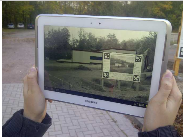
Abbildung 4: Augmentierung eines virtuellen Gebäudemodells mit Hilfe eines Verbundmarkers am Gelände der Hochschule Anhalt, Foto: ©Fraunhofer IFF
