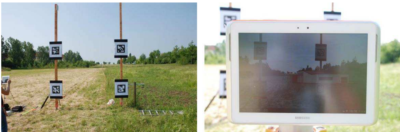
Abbildung 5: Distanzversuch zur Plausibilitätsprüfung der entwickelten Systemkomponenten in ArchKM-AR (Quelle: ©Fraunhofer IFF)
