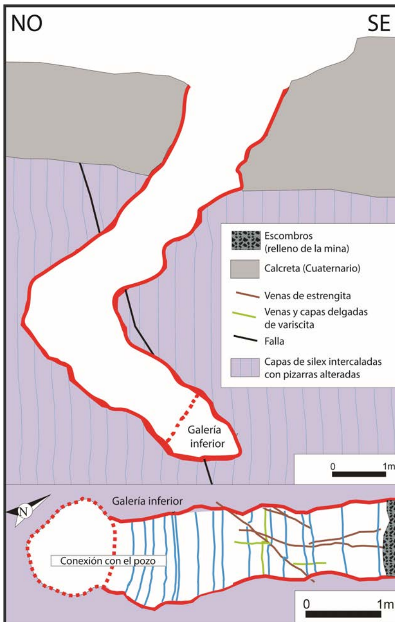
Figura 31. Arriba: Perfil geológico a lo largo del pozo de la mina 16, con trabajos mineros del Neolítico indicados en rojo. Abajo: Planta de la galería inferior, mostrando vetas y niveles de fosfato (modificado de Díaz Acha et al., 2019a).
