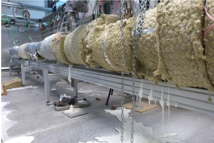
Abbildung 39: Leckage an beiden Ventilen während des Versuchs TK1/V3/R3.
