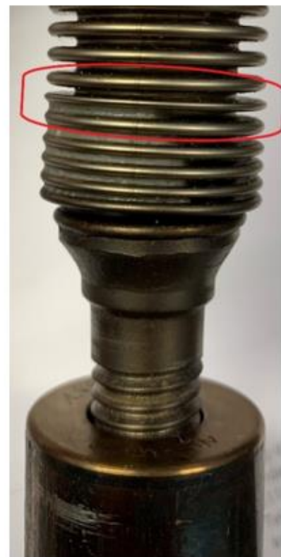
Abbildung 59: Undichtigkeit nach Beschädigung der Packung und Spindel durch solides Salz im Ringspalt (links). Gestauchter Faltenbalg mit solidem Salz in den Ringspalten des Kompensators (rechts).
