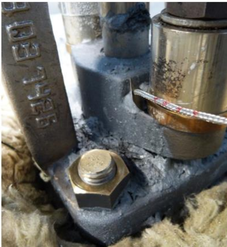
Abbildung 59: Undichtigkeit nach Beschädigung der Packung und Spindel durch solides Salz im Ringspalt (links). Gestauchter Faltenbalg mit solidem Salz in den Ringspalten des Kompensators (rechts).
