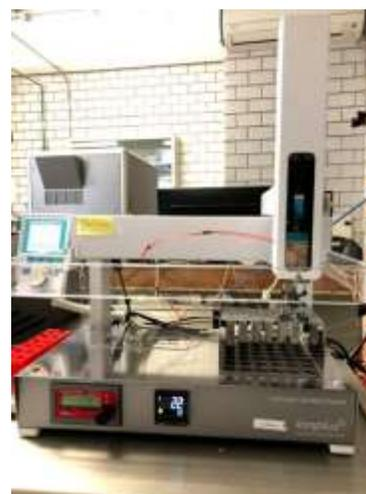
Figura 2. Sistema de manejo de carbonatos Ion Plus.
