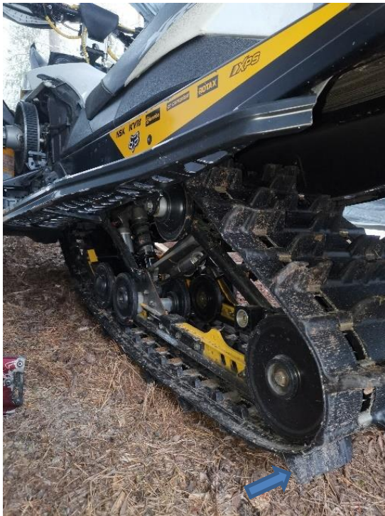
Kuva 6. Lyhyttelaisen moottorikelkan telamatto 44 mm harjakorkeudella.
