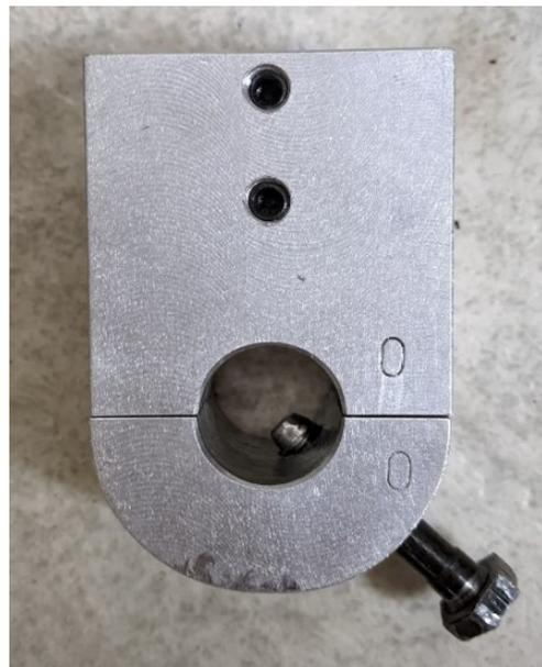
Figure 4.7 : A) Trou utilisé dans l'arbre pour empêcher le glissement.
