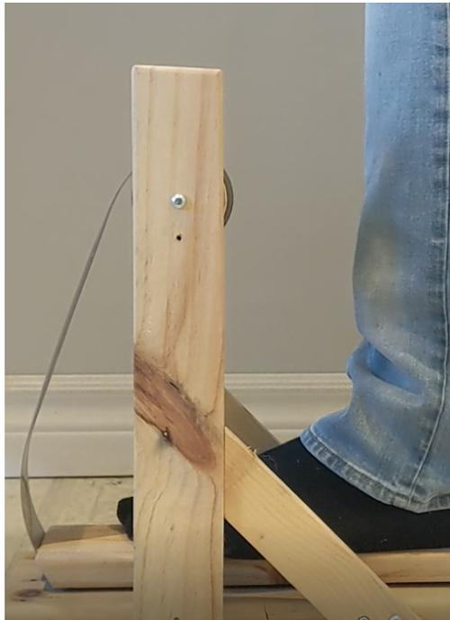
Figure 4.1 : Prototype montrant la trajectoire des ressorts.
