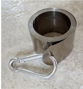
Figure 4.4 : Mousqueton dans l'ouverture située à l'extrémité d'un ressort.
