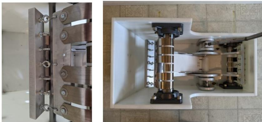
*Figure 4.9 : Utilisation de boulons et écrous pour la sélection des ressorts.*
